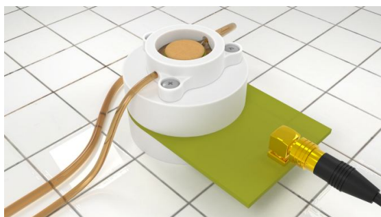
Figure 2. Cellule de mesure dédiée à l'étude microrhéologique d'explants de peau maintenus en survie
