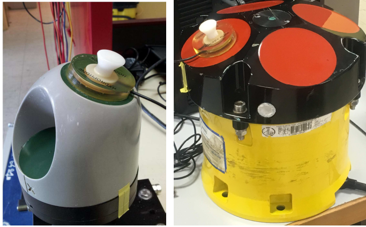
Figure 2 : hydrophone posé sur un profileur NORTEK 600 kHz et sur un profileur Workhorse RDI.
