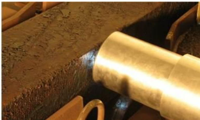
Figure 2. Extrait modifié de [3] montrant une analyse LIBS sur un bloom d'acier sur un tapis roulant
