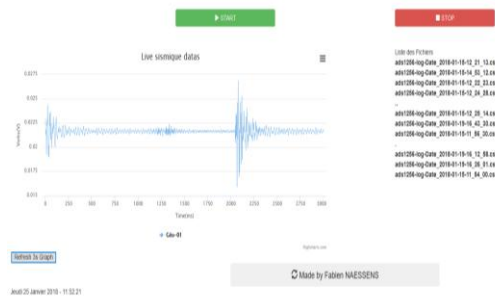
Figure 4 - Sismographe terrain basse fréquence
