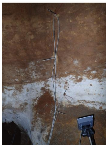
Figure 2. Positionnement des capteurs de température air/roche et capteur de dioxyde de carbone au premier plan sur la paroi gauche de la Salle du Trône de la grotte de Leye
